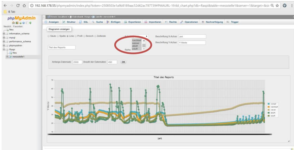
Hier können die Kurven der Messsonden ab- und wieder zugeschaltet werden.
