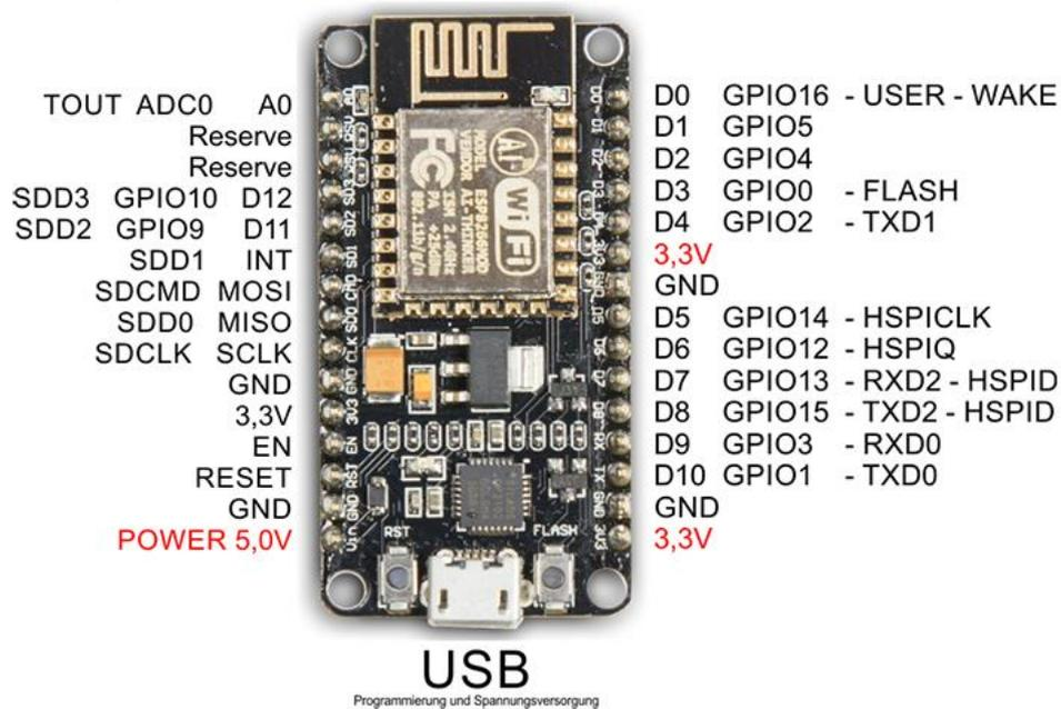
Über die USB-Schnittstelle (5V) wird der ESP8266 mit Strom versorgt und gleichzeitig auch programmtechnisch bedient. Die Stromaufnahme in unserem Fall liegt bei maximal 50mA.
